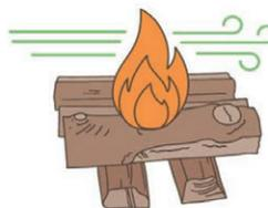
Ausreichende Luftzufuhr beachten! Bereits vor dem Anzünden sollten die Luft- und Drosselklappen weit geöffnet werden. Die Klappen dürfen erst geschlossen werden, wenn sich ein Glutstock gebildet hat. Bei Dauerbetrieb kontinuierlich Holzscheite nachlegen.
